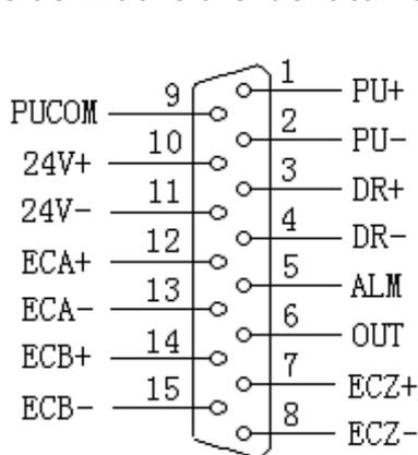
CNC4240 Pulse wiring
